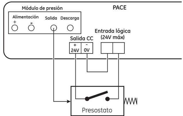
**Ejemplo de conexión para prueba de presostato**
