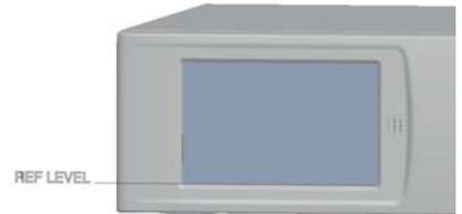
Cuando calibre el instrumento PACE, desactive la corrección de cabecera de gas y corrija las presiones aplicadas para la altura.
