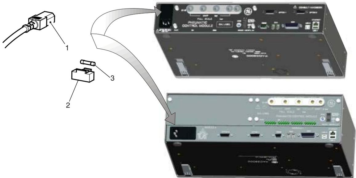
1 Conector de alimentación IEC    2 Portafusibles    3 Fusible
