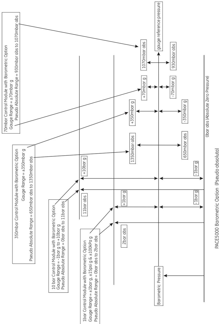
Consulte en las hojas de datos SDS 0001 y SDS 0008 la información sobre la referencia barométrica y la precisión de los rangos absolutos.
