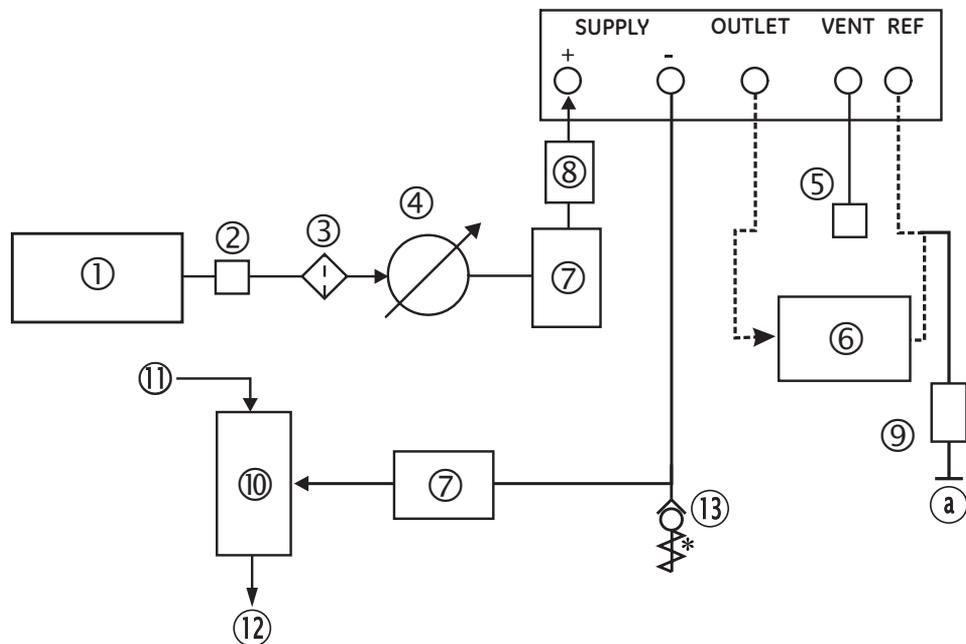
**Figura 2-4. Conexiones neumáticas con generador de presión manométrica negativa**
