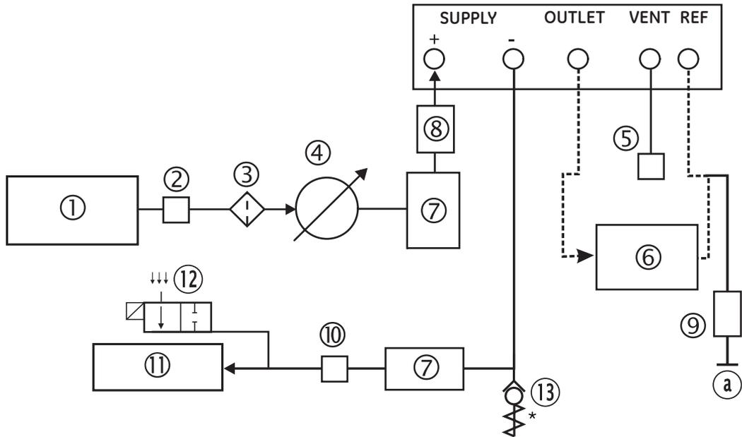
**Figura 2-3. Conexiones neumáticas con alimentación de vacío**
