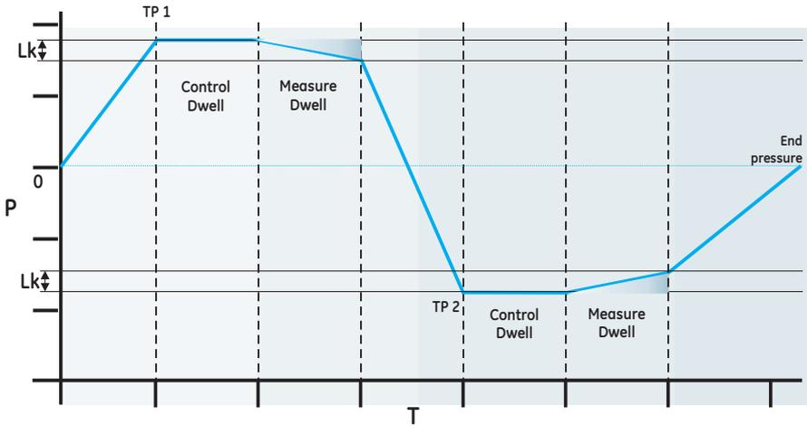
lk = fuga P = presión T = tiempo (segundos) TP = presión de prueba
