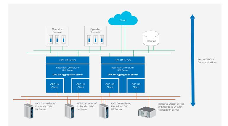
Figure 17 - OPC UA System Architecture
