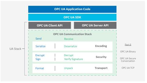
Figure 6 - OPC UA Communication Stack
