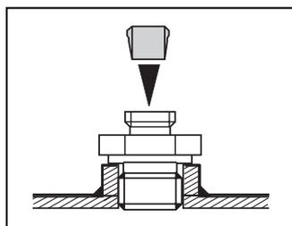
4. Visser l'écrou et insérer la sonde (D).
