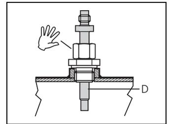
5. Serrer l'écrou manuellement et le marquer d'un trait (E).
