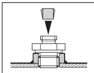
4. Schrauben Sie die Überwurfmutter auf und setzen Sie den Sensor (D) ein.
