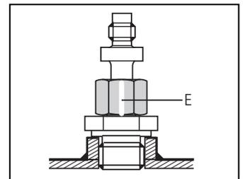
6. Insérer la sonde jusqu'à la profondeur souhaitée. La tenir et serrer l'écrou en faisant 2 tours complets à l'aide d'une clé.
