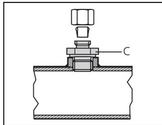
2. Fetten Sie alle Teile des Adapters ein: Überwurfmutter (A), Progressivring (B), Gewinde und Konus der Verschraubung (C).
