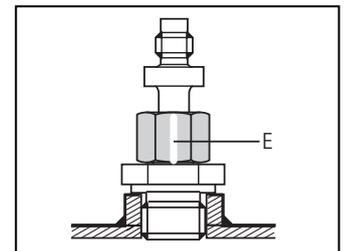
6. Schieben Sie den Sensor auf die gewünschte Tauchtiefe. Halten Sie ihn fest und ziehen Sie die Überwurfmutter mit einem Werkzeug um 2 volle Umdrehungen an.
