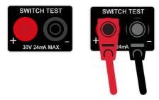
**Fig. 4** Switch Test input
