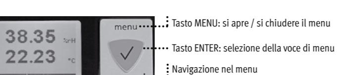
**Nota:** è possibile evitare un accesso non autorizzato al menu bloccando l'opzione "Display Menu" (se si utilizza il software HW4 > Manager strumenti > Display).
